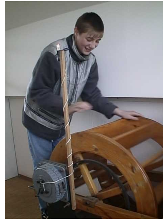
Vodní kolo je uloženo v ekologické laboratoři a připojeno k ovládacímu panelu. Poháníme jej zatím jen lidskou silou
